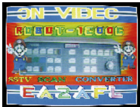
Bild 8: Ein auf 20 m empfangenes SSTV-Bild. In der Mitte des Bildes der Original-Konverter Robot 1200
