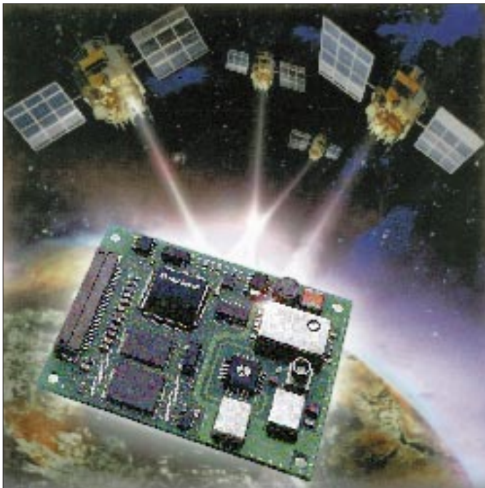
Der GPS-Empfänger „NavCore Microtracker“ ermöglicht die Positionsbestimmung über Satelliten.
