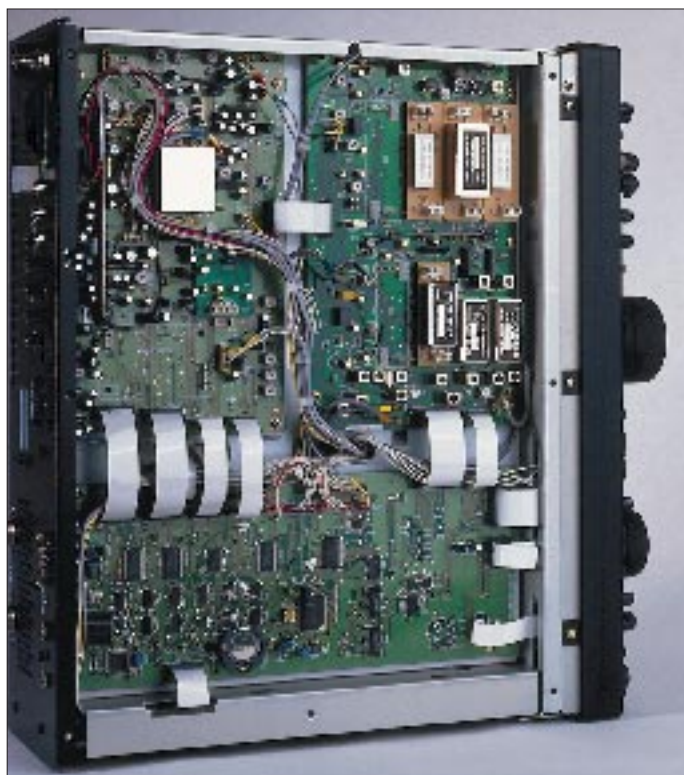
Bild 3: Die Innenansicht der Unterseite des FT-1000MP zeigt drei Haupt-Leiterplatten, auf die „huckepack“ weitere aufgesteckt sind. Es ist Platz für allerlei nachrüstbare Filter für beide Zwischenfrequenzen, 8,215 MHz und 455 kHz, vorhanden. Das 500-Hz-Zusatzfilter für den Zweitempfänger ist hier bereits eingebaut.
