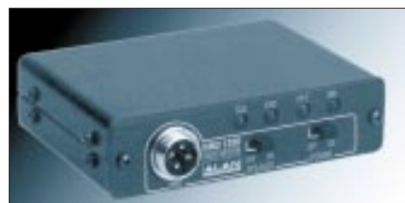
Bild 2: Mit dem RMD 1200 stellt die Firma ALAN ELECTRONICS ein Modem für Packet-Radio-Verbindungen im CB-Funk zur Verfügung.
