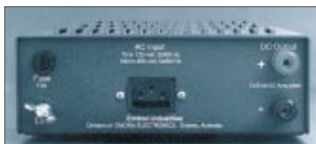
Stabile Erd- und Ausgangsklemmen sorgen für geringe Übergangswiderstände.
